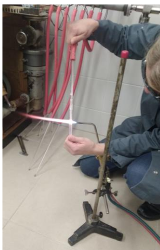
Figura 3-9: Dettaglio di una fase del processo di crescita via MSS: la sigillatura con cannello ossiacetilenico di un'ampolla di quarzo collegata ad una rampa per la selezione dell'atmosfera interna.
