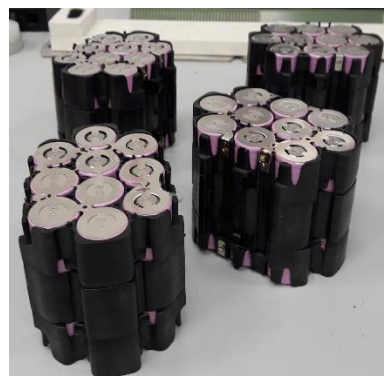
Figura 3.3 – Pacco celle della batteria Bosch con cui è equipaggiata la ebike.
