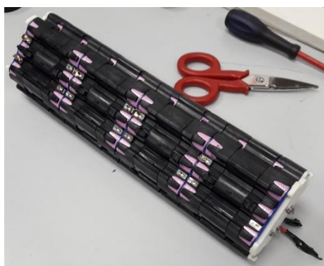
Figura 3.3 – Pacco celle della batteria Bosch con cui è equipaggiata la ebike.
