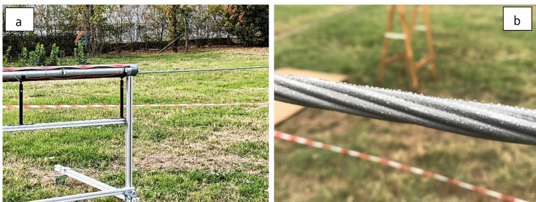
Figura 6-3 – Preparazione delle funi di guardia. a) forno tubolare e fune tesa; b) prova di idrofobicità della fune rivestita.
