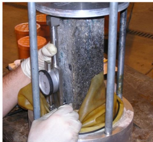
Figura 3 – Prova di invecchiamento di un provino di calcestruzzo - Misura di espansione.
