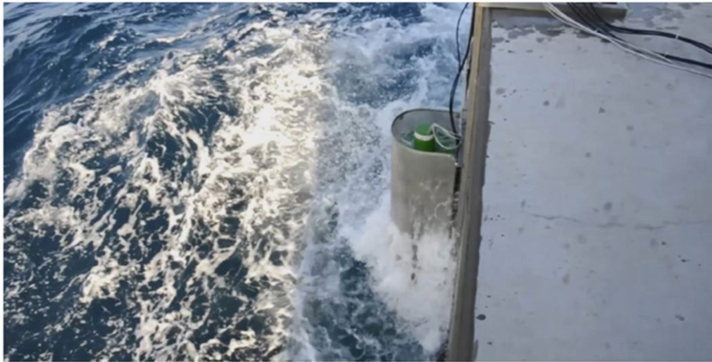
Figura 3: Prove a mare del WaveSAX presso il Porto di Civitavecchia (Ottobre 2018)
