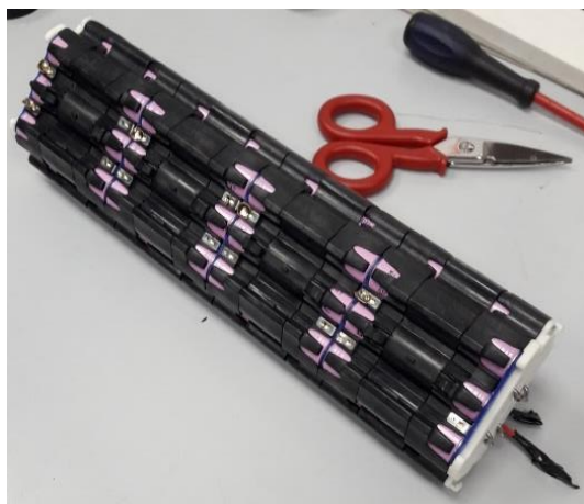
Figura 2. Pacco celle della batteria Bosch della eBike
