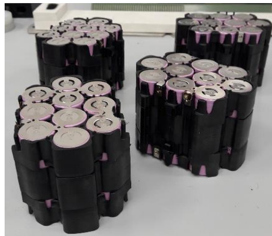
Figura 2. Pacco celle della batteria Bosch della eBike
