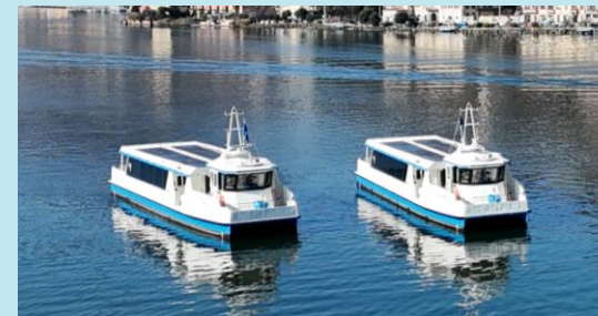
Sarnico E Sale Marasino II - Lago d'Iseo Alimentazione Elettrica Catamarani 26 m 140 passeggeri Batterie da 750 kWh
