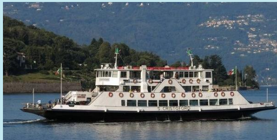
San Cristoforo- Lago Maggiore Alimentazione Ibrida Traghetto 45 m 450 passeggeri + auto Batterie da 268 kWh
