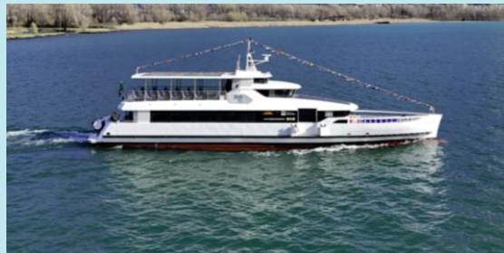
Predore- Lago d'Iseo Alimentazione Ibrida Motonave 30 m 149 passeggeri Batterie da 85 kWh
